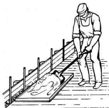
Рис. 74. Использование настила при бетонировании стены
