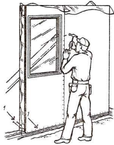
Рис. 31. Монтаж наружной стены из мелко-размерных панелей
