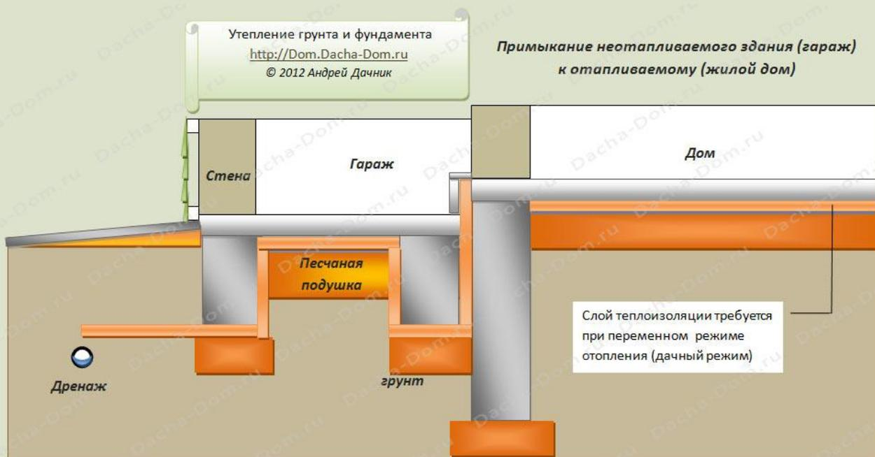
Если у отапливаемых зданий имеются холодные пристройки, например, террасы, гаражи, то горизонтальный пояс утепления охватывает все заблокированные с домом пристройки. Ее параметры на участке пристройки рассчитываются как для неотапливаемого здания. Также требуется теплоизоляция между фундаментами неотапливаемой и отапливаемых частей здания, для предупреждения теплопотерь через мост холода. Подлежащий грунт под неотапливаемой частью здания полностью изолируется утеплителем от фундамента.
