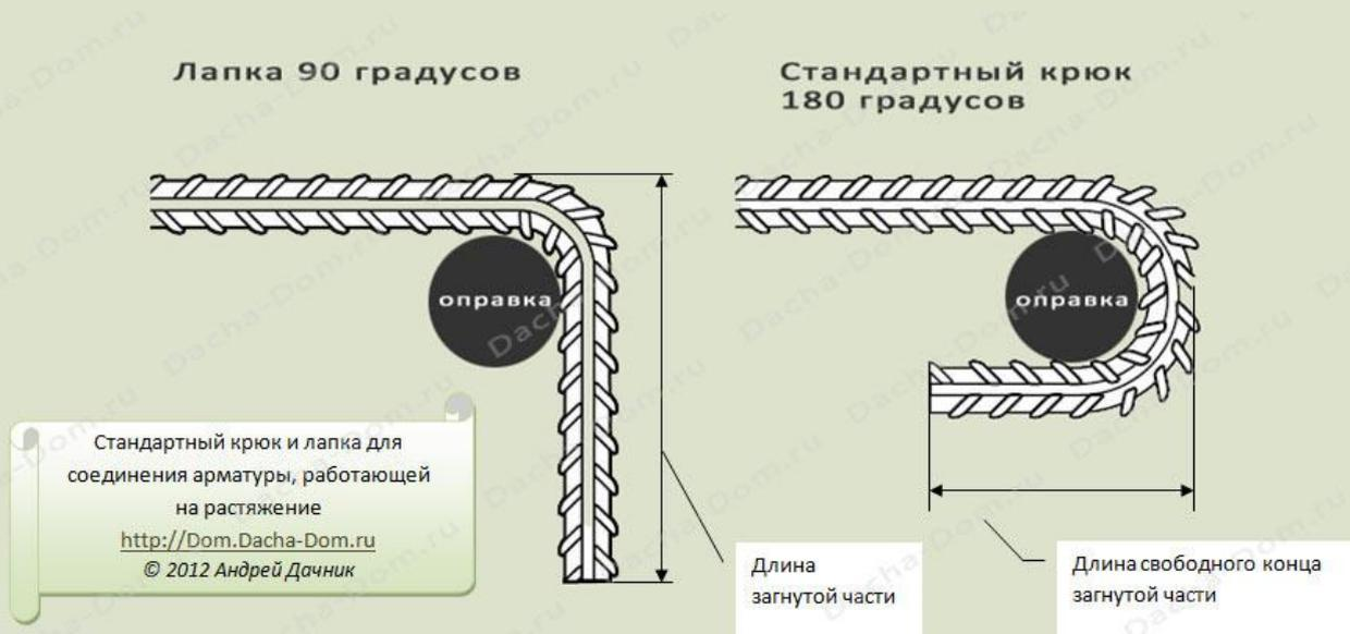
Таблица №54 Рекомендуемые основные размеры стандартного крюка и лапки для соединения арматуры, работающей на растяжение\*
