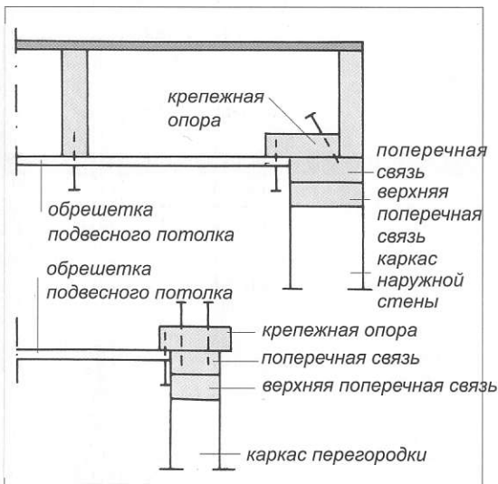
Рис. 38 б Крепление крепежных опор обрешетки потолка к поперечным связям в стенах параллельно балкам.
